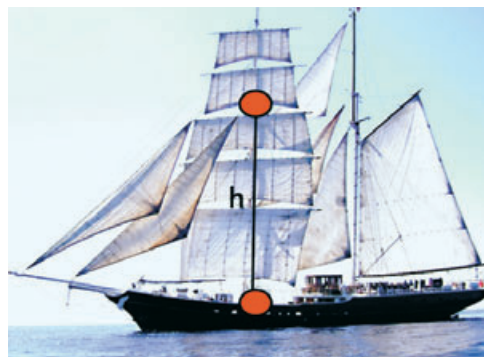
Figura 4. Nave Italia e la posizione del ponte e della seconda coffa. L'altezza h è risultata 24,5 m.
